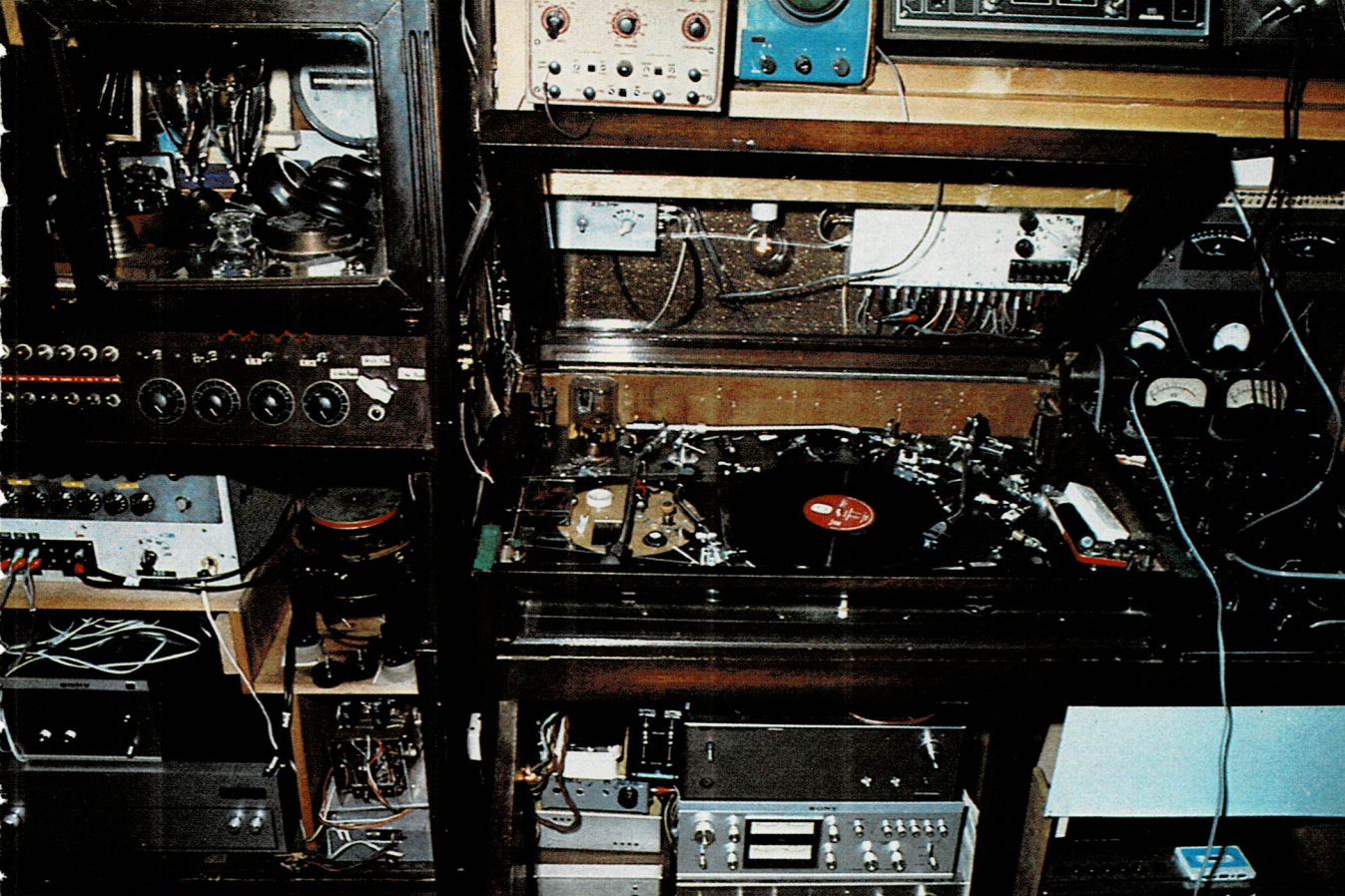
中央が自慢の糸ドライブ式超重量級ターンテーブル プレイヤー右側のコントロール・アンプは自作 左の中ほどにドライブ用のテレフンケン77極モーターがある
