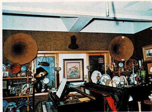
氏の4ウェイ・オールホーン・スピーカー・システム カットオフは225Hz 1000Hz 7000Hz 低音用ホーンのドライバーは真下ではなく 部屋の中央を向いている
